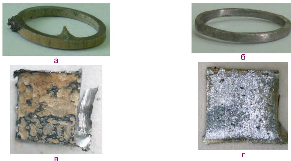
Рис. 2.11. Внешний вид образцов до (а, в) и после (б, г) удаления оксидной плёнки
