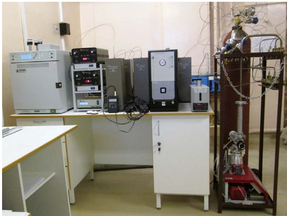
Рис. 1.2. Внешний вид газоаналитического комплекса петлевой установки ПГ-1
