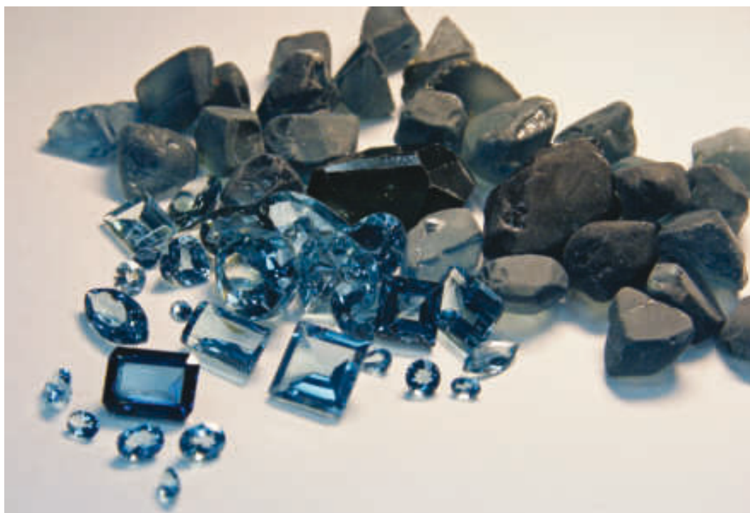
Топазы до и после радиационного окрашивания в реакторе РБТ-10/2
