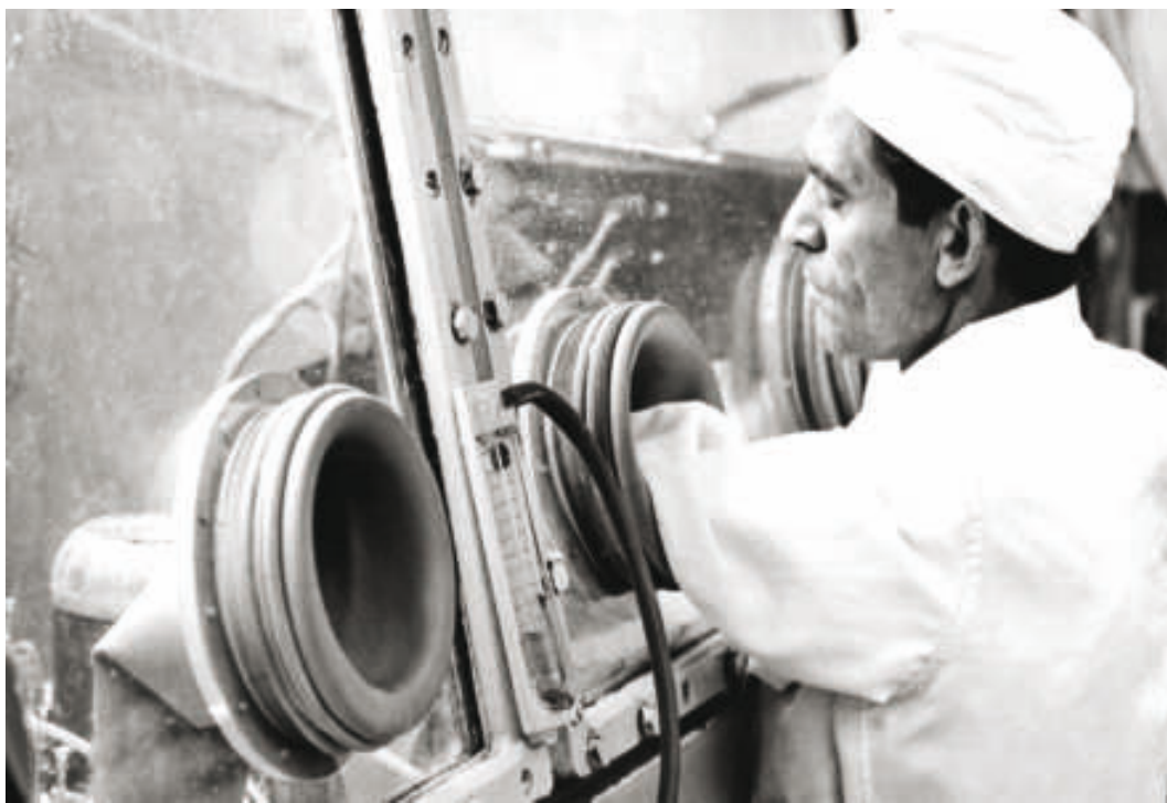
Наладка оборудования в перчаточном боксе
